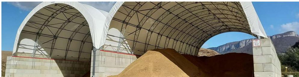
**Figura 4.2.1.** Detalle del cerramiento propuesto para la recepción de residuos sólidos.
