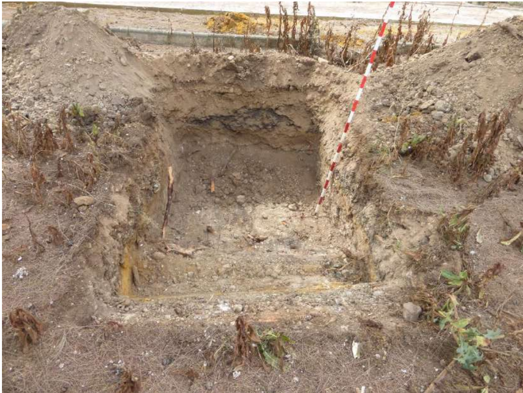
Excavación del sondeo 11. Se documenta capas de relleno de mortero y restos de cal.
